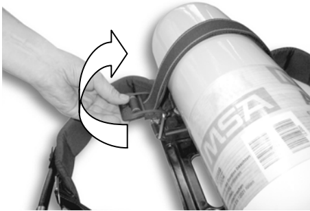
Bild 9 Entfernen der Druckluft-Flaschen
