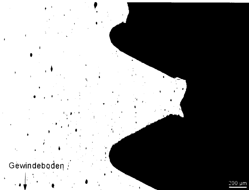
Bild (fig.) 26 : geteilte Gewindespitze Ätzmittel (etching solution) : ungeätzt
