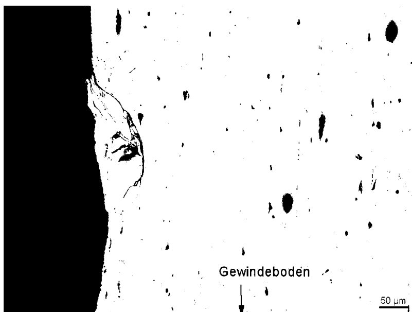
Bild (fig.) 31 : anormaler Gewindebereich Ätzmittel (etching solution) : ungeätzt
