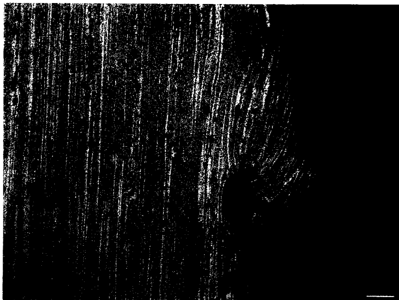
Bild (fig.) 25 : Mikrogefüge, Verformung der Gewindeflanke in Richtung Sackloch Ätzmittel (etching solution) : HBF4 elektrolytisch (polar. Licht)
