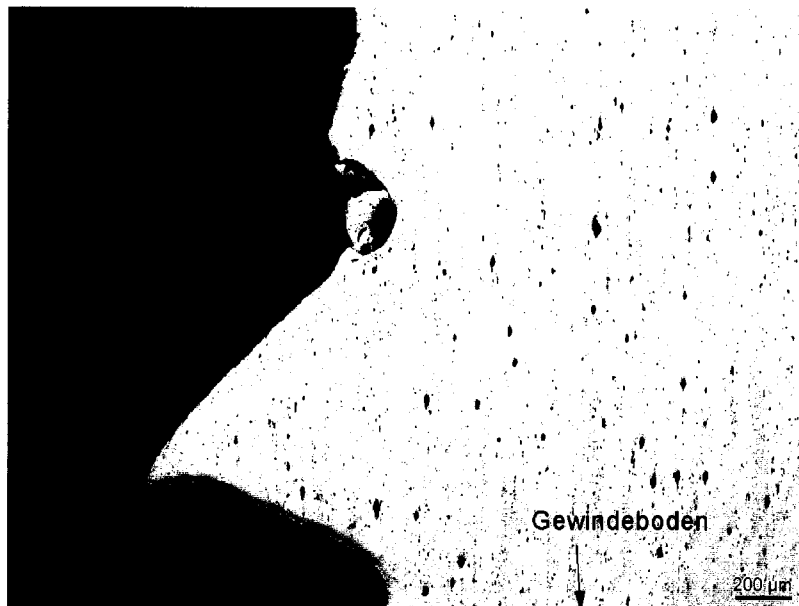
Bild (fig.) 20 : Verformung der Gewindeflanke in Richtung Sackloch Ätzmittel (etching solution) : ungeätzt
