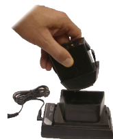
Einsetzen der Batterie In den Schacht
