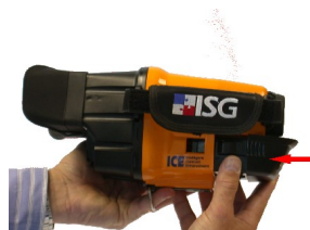
Einsetzen der Batterie
